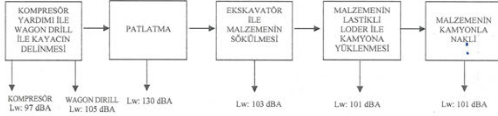
Şekil 1. K-1, K-2, K-3A, K-5, K-6A, K-6B Kaya Malzeme Ocakları Üretim Akım Şeması ve Ses Gücü Seviyeleri
