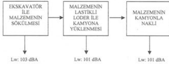
Şekil 2. A,B,C,D,E,F,G Geçirimli ve Geçirimsiz Malzeme Sahaları Üretim Akım Şeması ve Ses Gücü Seviyeleri
