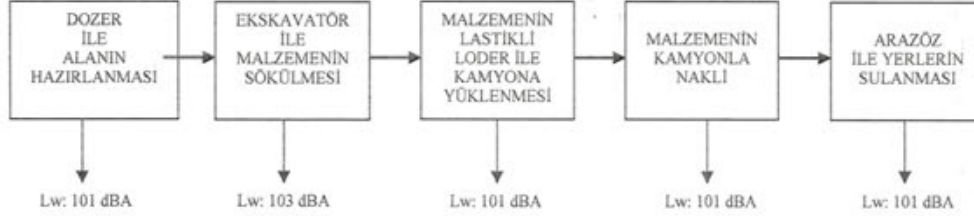
Şekil 5. Baraj Gövdesi İnşaatı Akım Şeması ve Ses Gücü Seviyeleri
